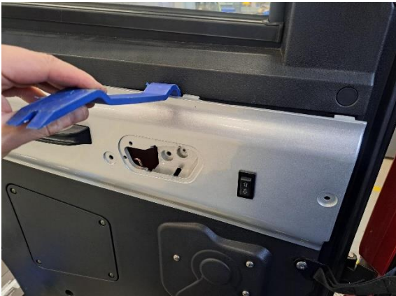
Irrota oven sisäpuolen koristepaneelin yläpää (muovinen sorkkarauta).
